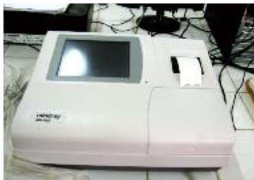
L'appareil ELISA de marque MINDRAY MR 96 A pour l'examen de liquides biologiques
