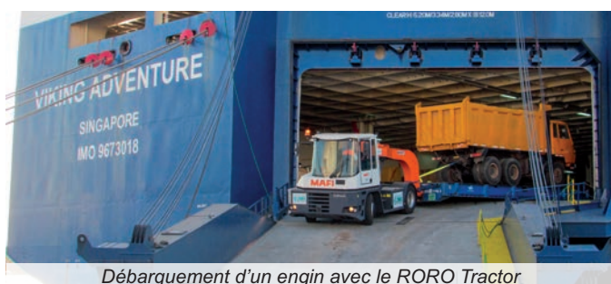
Brouettage d'un engin par RORO Tractor et la remorque porte-char
