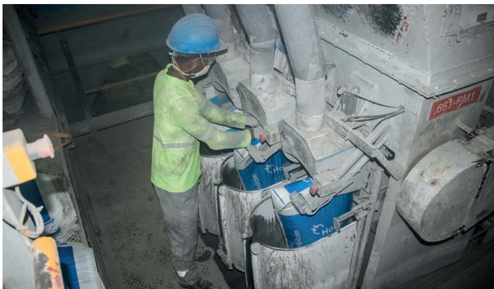
Opération d'ensachage de ciment en vrac
