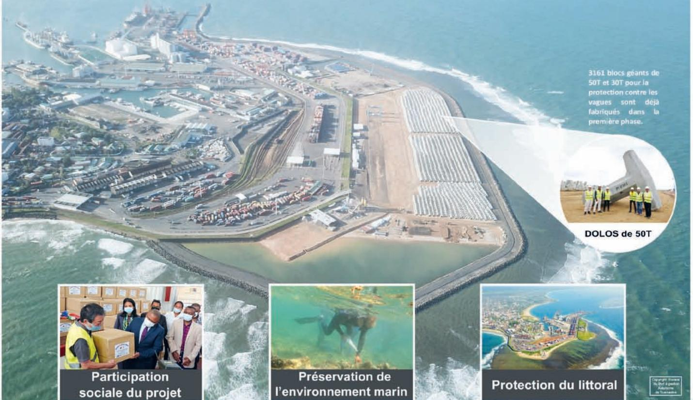
3161 blocs géants de 50T et 30T pour la protection contre les vagues sont déjà fabriqués dans la première phase.
